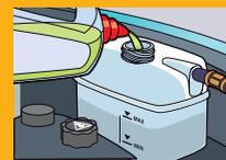
**4** | Le niveau doit se situer entre le **mini et le maxi**. Faites l'appoint si le niveau est proche du mini. Faites contrôler votre voiture s'il est en dessous pour éviter une surchauffe moteur.
